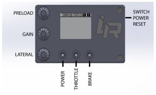
Le panneau de contrôle permet de régler le tensioneur en direct.
